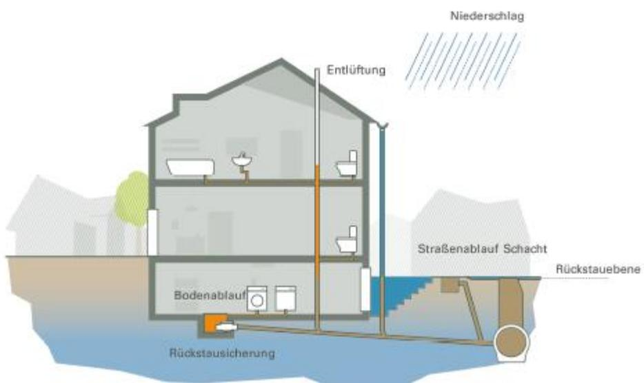
Abbildung 8, mit Rückstausicherung
